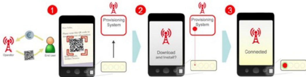
Figura 2: Provisionamento remoto do e-SIM Card, instalação do perfil da operadora (peça 21, p. 5)
